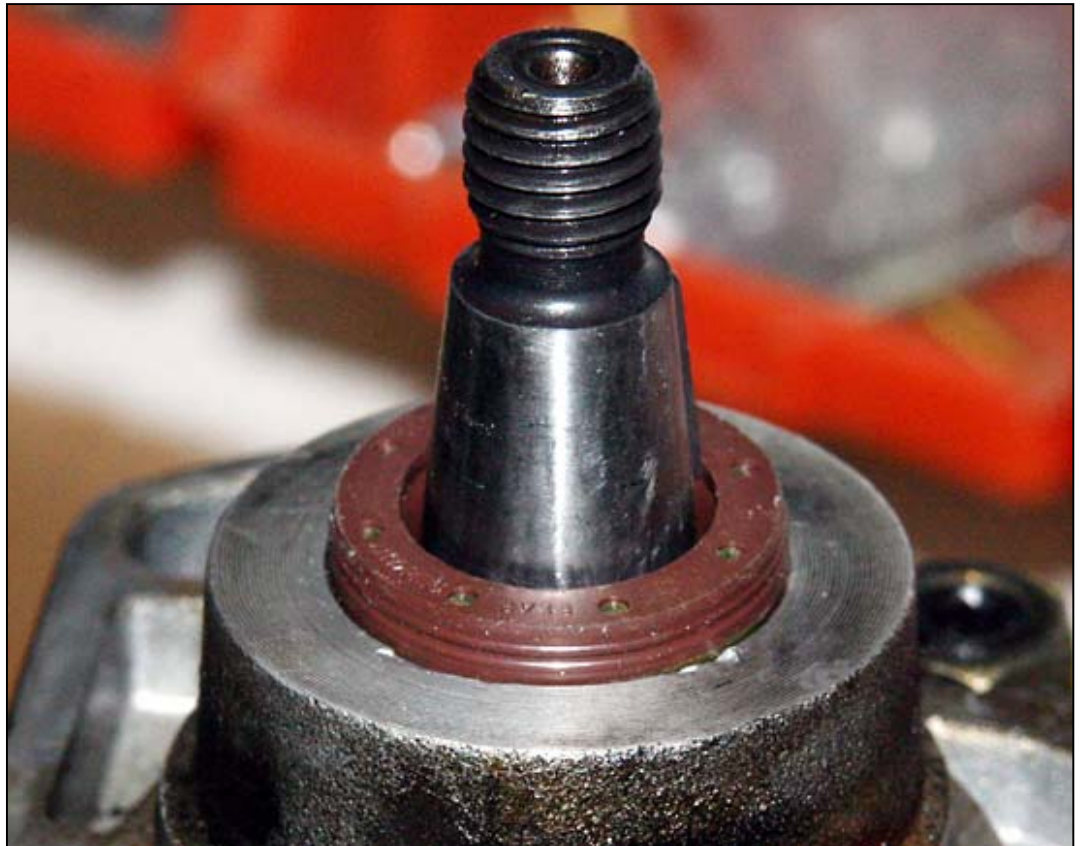
Bild 9: Neuer Wedi bereit zum Einschlagen - vorher einfetten/-ölen
