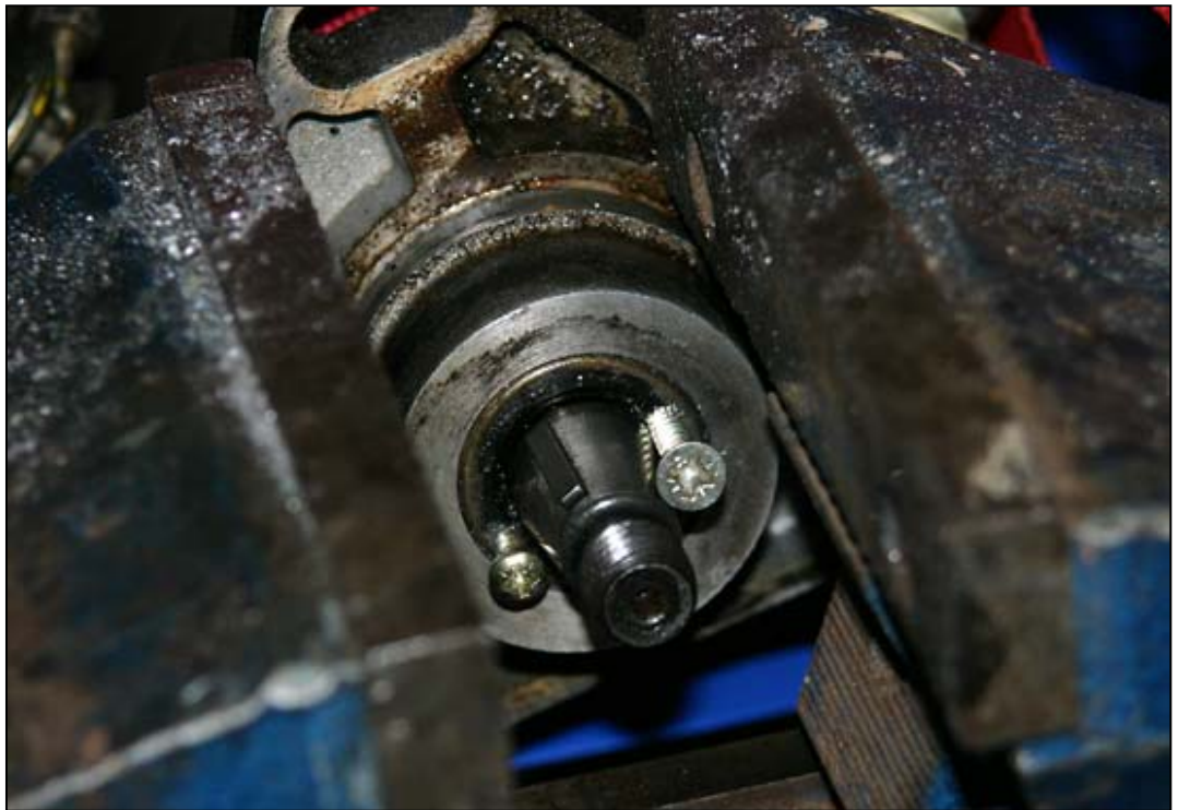
Bild 4: Ein Schraubstock zum Gegenhalten beim Ziehen, aber der Wedi geht nicht raus...
