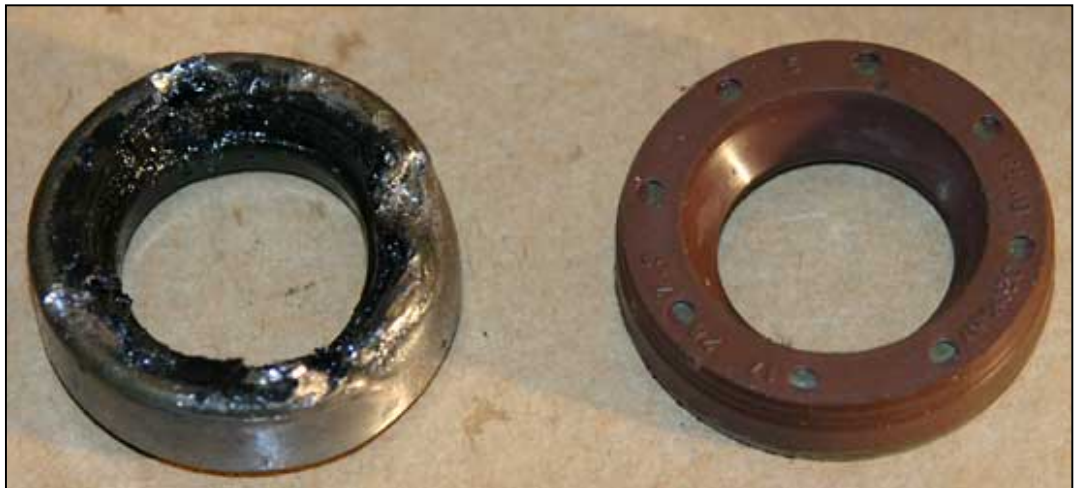
Bild 7a: Alter Wedi - neuer Wedi (Rückseite)
