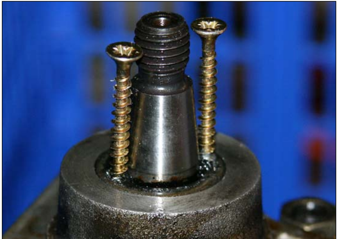
Bild 3: Zwei Spax-Schrauben im Wedi zum Rausziehen des Wedis
