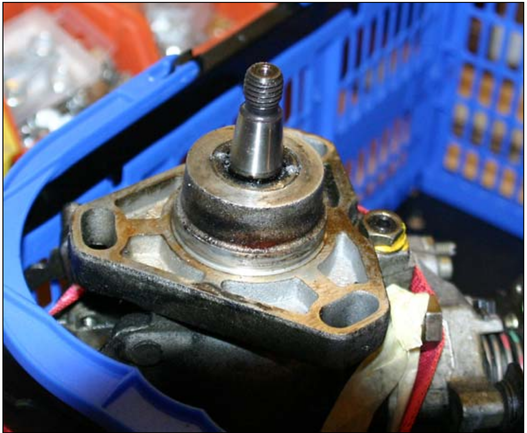
Bild 2: Der Wellendichtring hat nun zwei 2 mm Löcher
