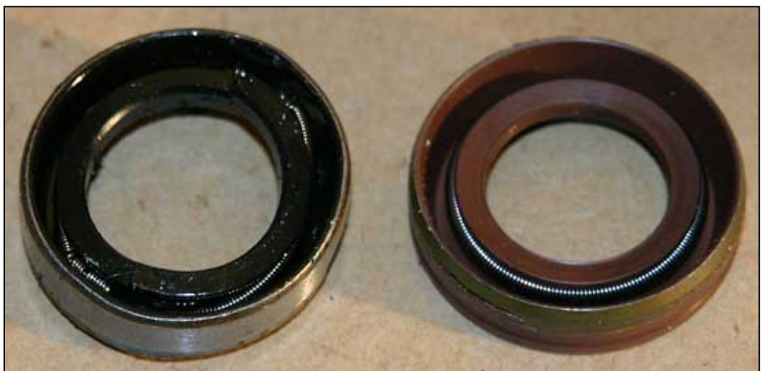
Bild 7b: Alter Wedi - neuer Wedi (Rückseite, man sieht den Federring)
