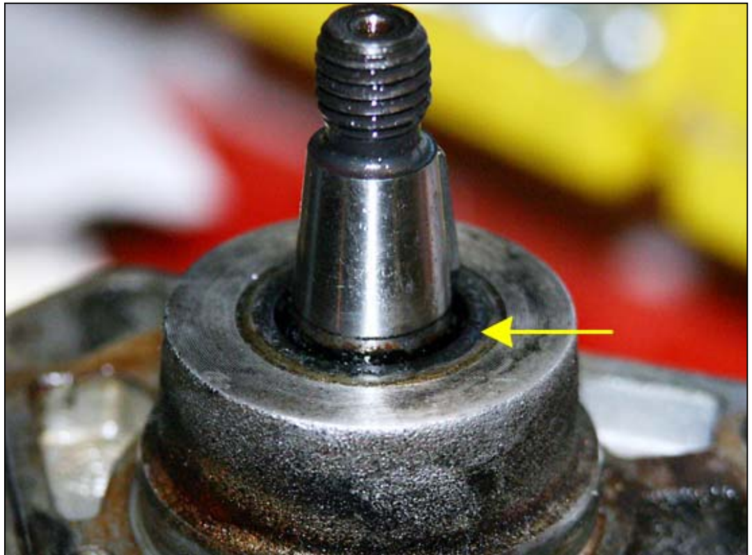
Bild 1: Die Welle der ESP mit dem alten Wellendichtring (Pfeil)
