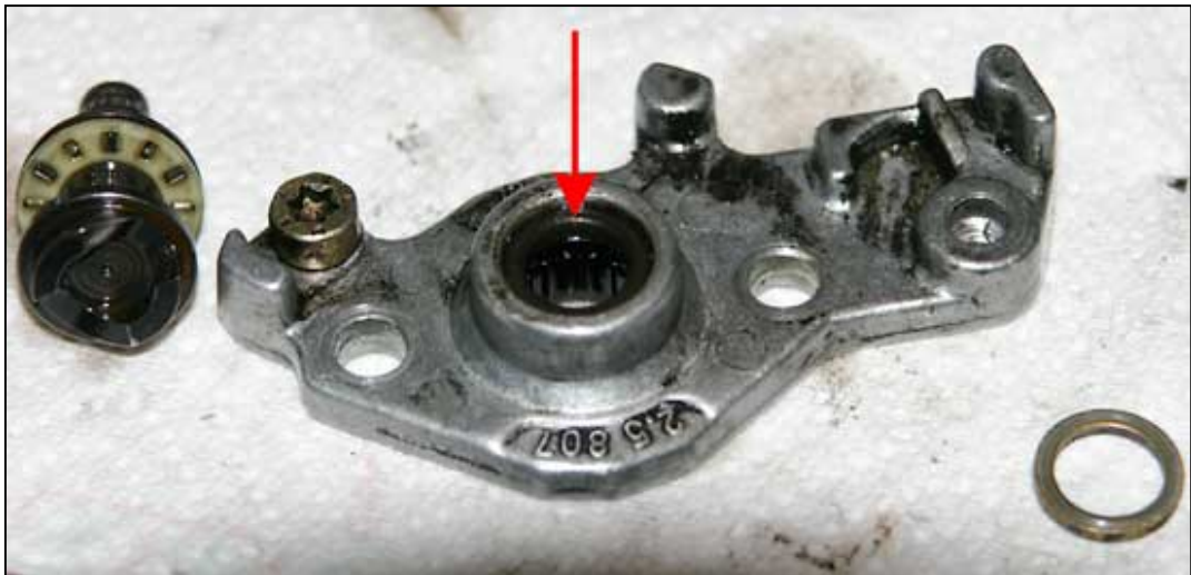
Bild 1.10: KSB-Welle zerlegt. Getauscht wird der O-Ring (roter Pfeil)
