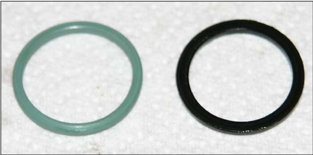
Bild 1.5: Der neue und der alte O-Ring
