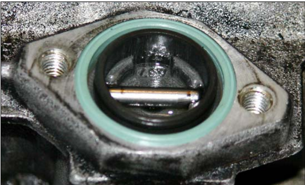
Bild 1.6: Der neue O-Ring ist montiert
