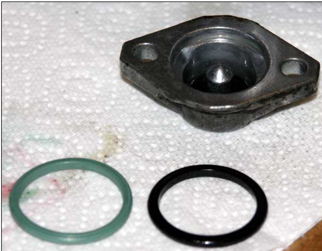
Bild 2.5: Der neue und der alte O-Ring und der Deckel
