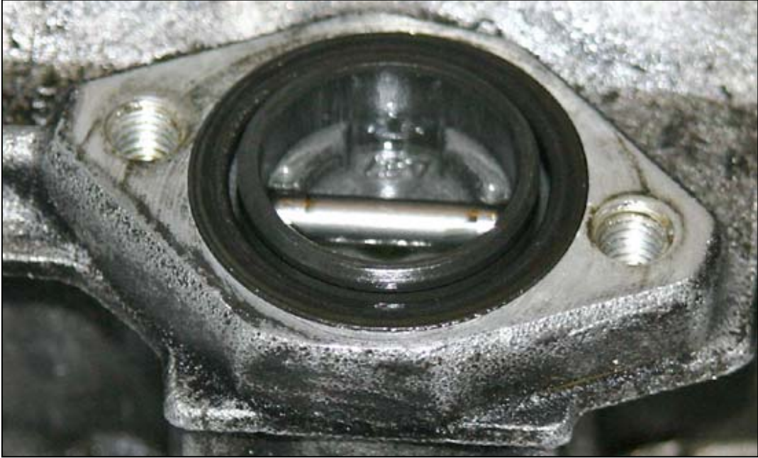
Bild 1.4: Die Öffnung des KSB mit dem alten O-Ring
