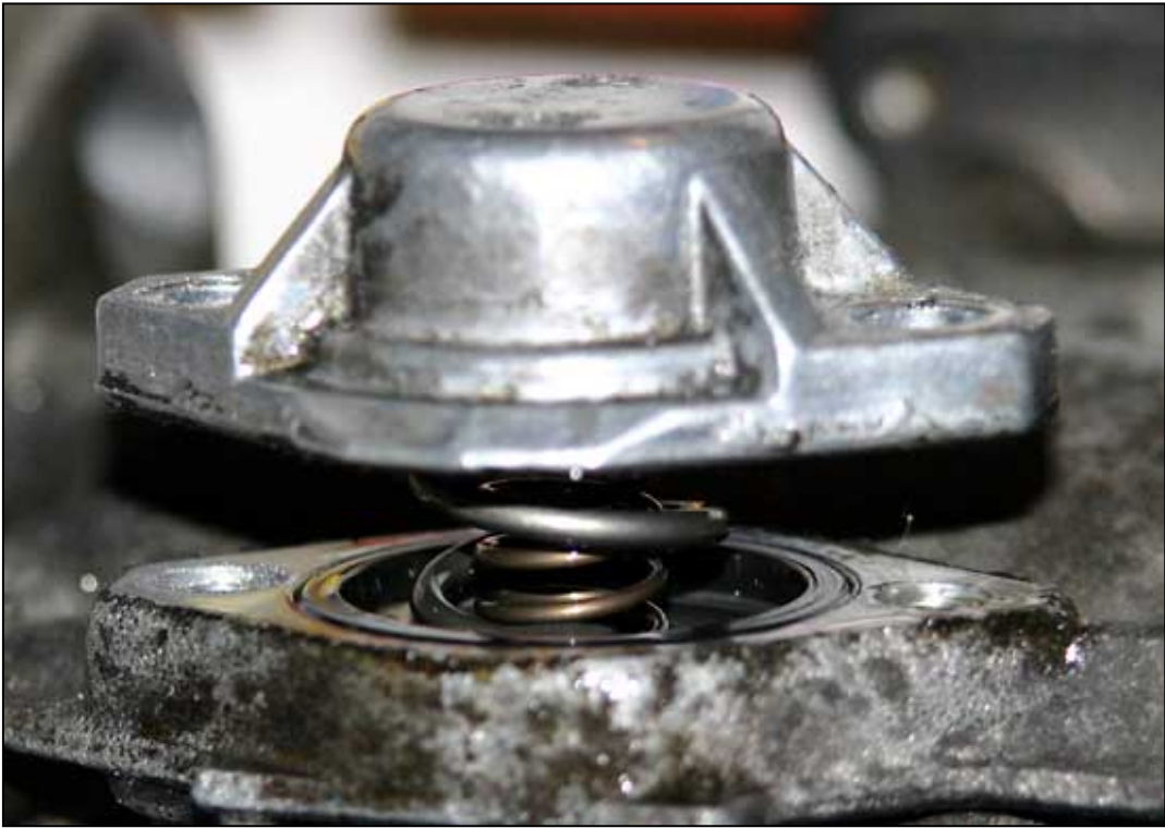
Bild 2.3: Der Deckel ist gelöst und sitzt noch auf den Federn
