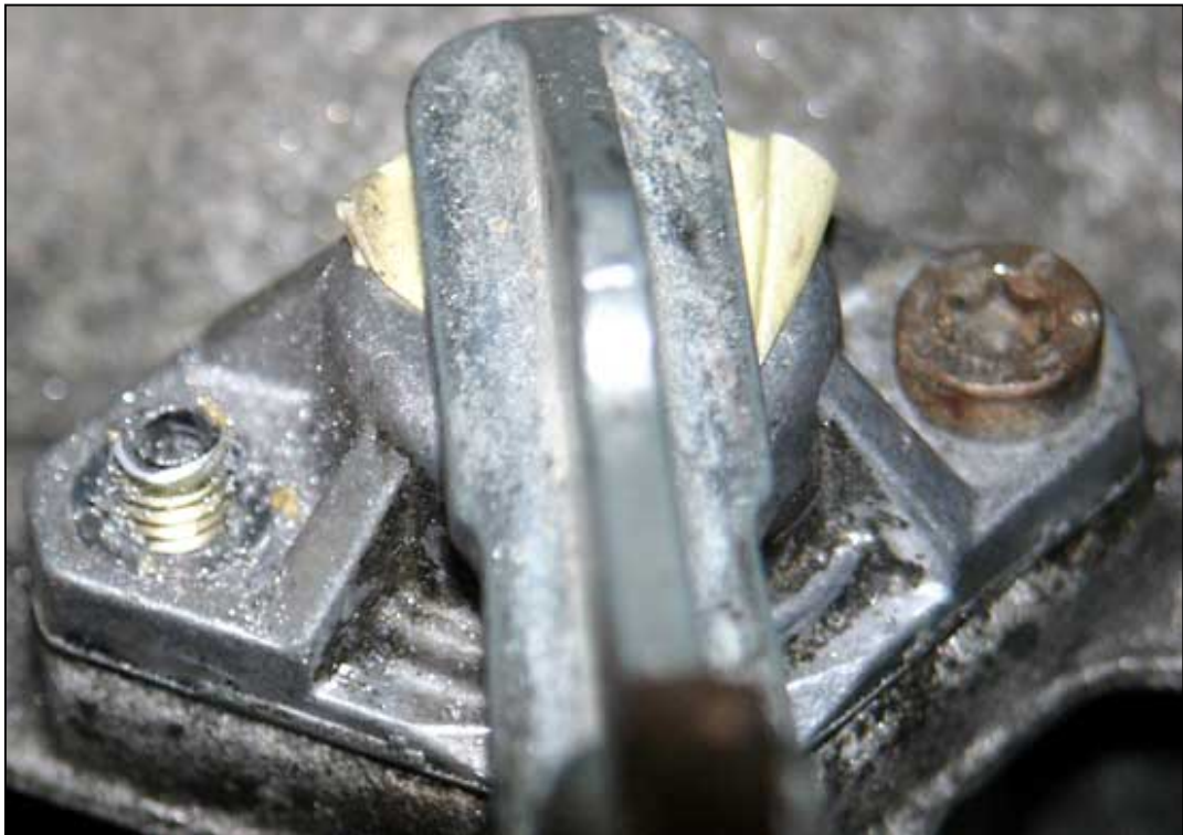
Bild 2.2: Ich musste eine Schraube ausbohren
