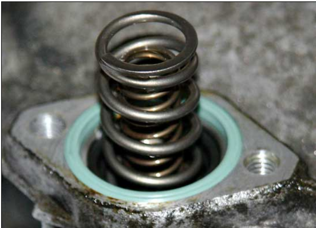
Bild 2.6: Der neue O-Ring in Position
