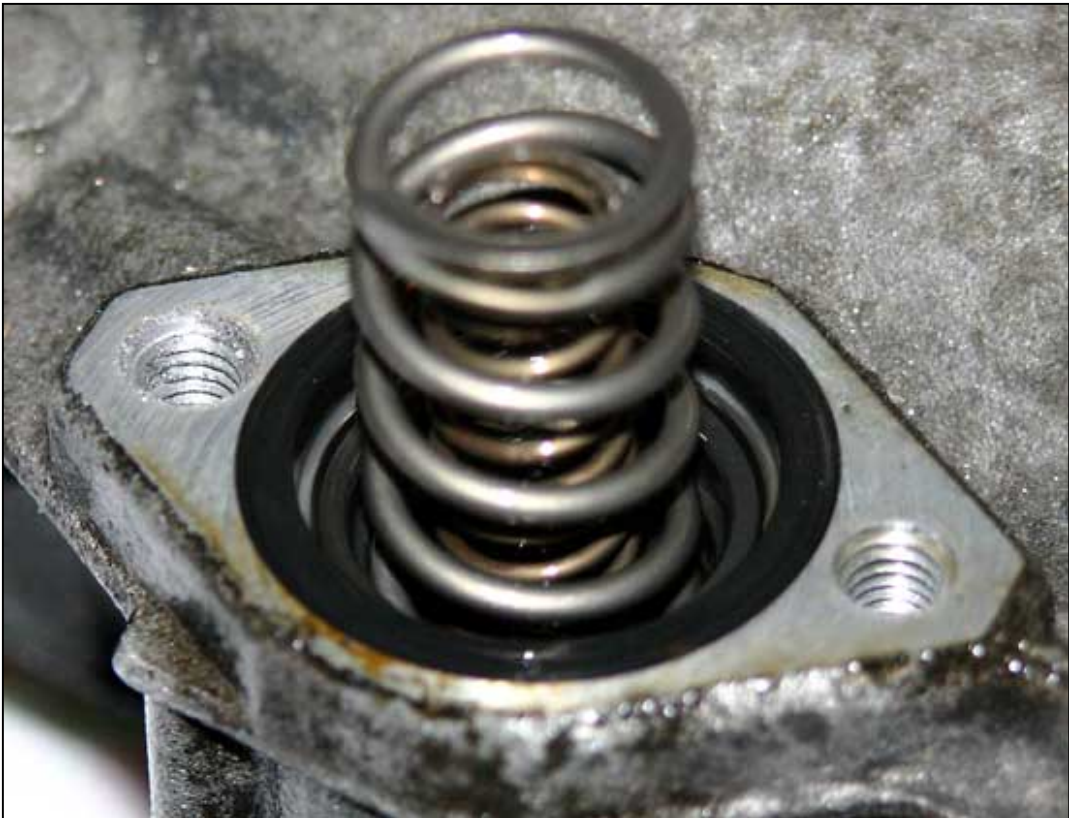
Bild 2.4: Der Deckel ist geöffnet und der O-Ring ist sichtbar.
