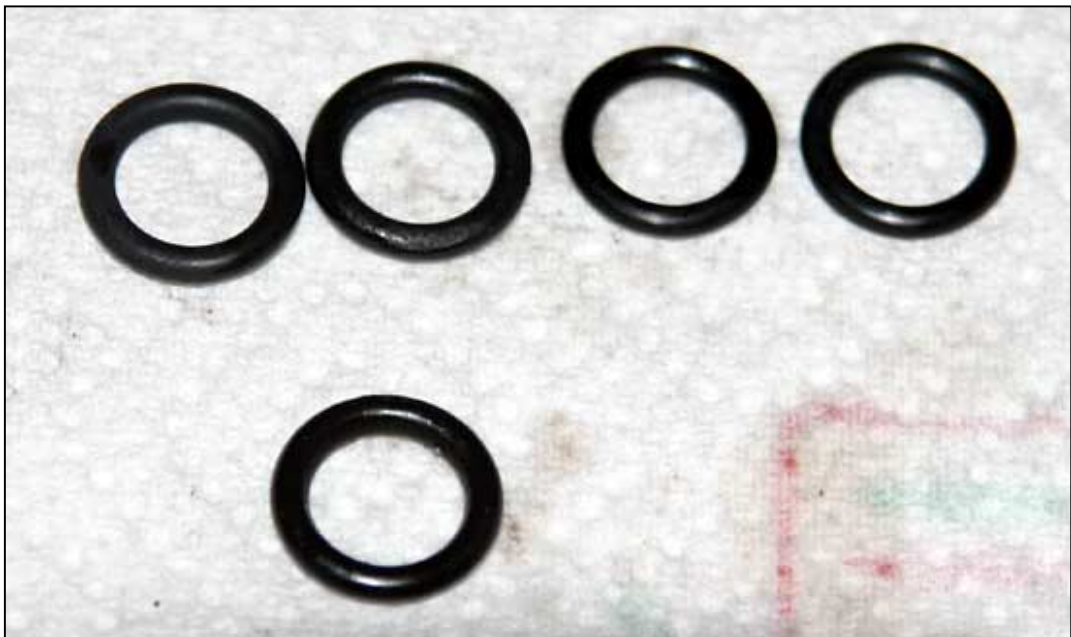
Bild 1.12: Unten der alte O-Ring, oben die möglichen Kandidaten als Ersatz
