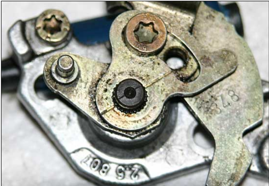
Bild 1.9: Welle mit Verzahnung und eindeutiger Markierung
