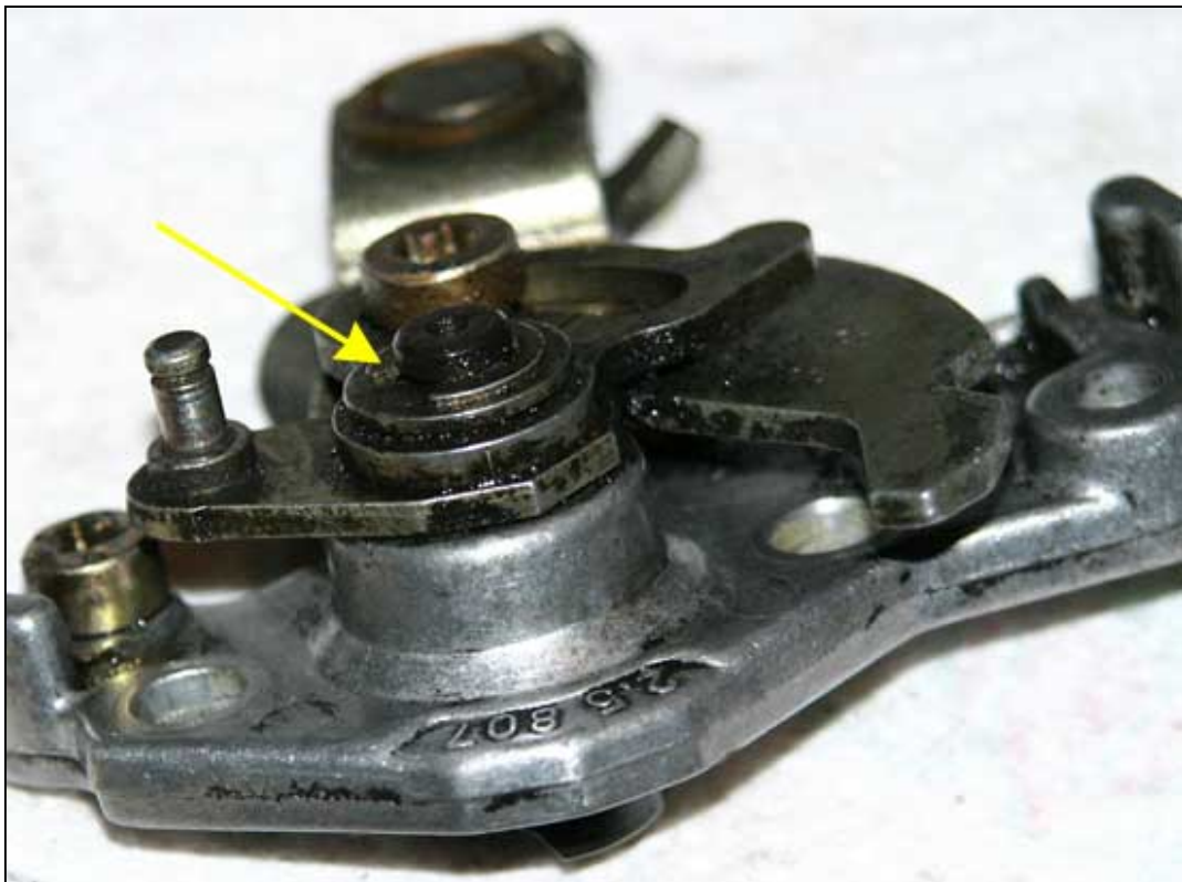
Bild 1.8: Sprengring der Welle lösen
