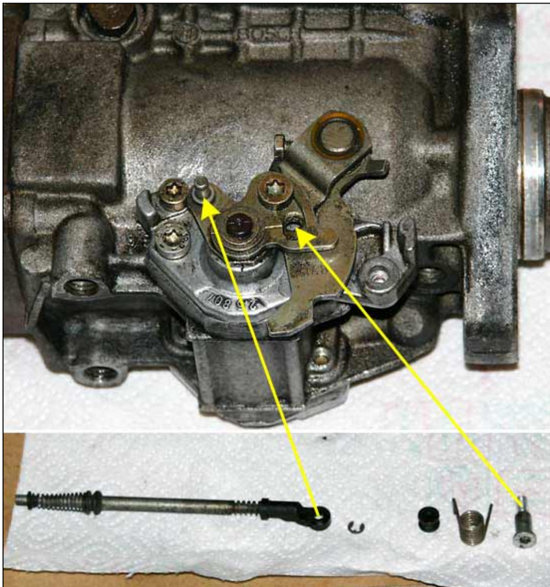
Bild 1.1: Der Kaltstartbeschleuniger der ESP VE4... mit demontierter Lenkstange (ja heißt so) und Montageteilen
