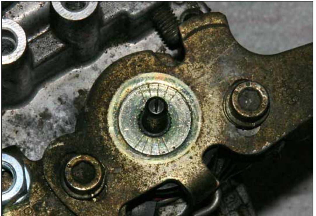
Bild 8: Die Verzahnung und Markierung zwischen Verstellwelle und Gashebel
