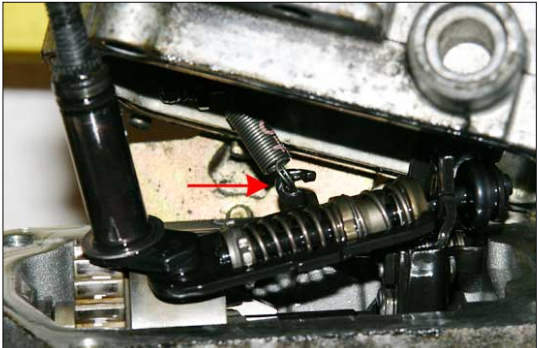
Bild 11: ... die Feder muss noch ausgehängt werden
