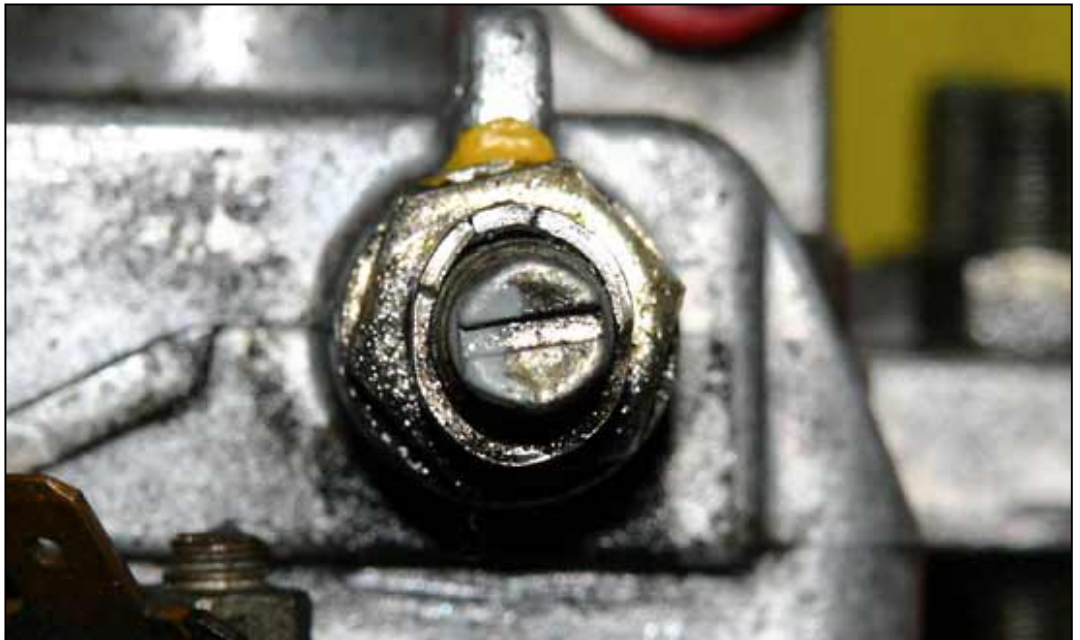
Bild 4: Position der Fördermengen-Schraube markieren (graue Farbe) und merken!
