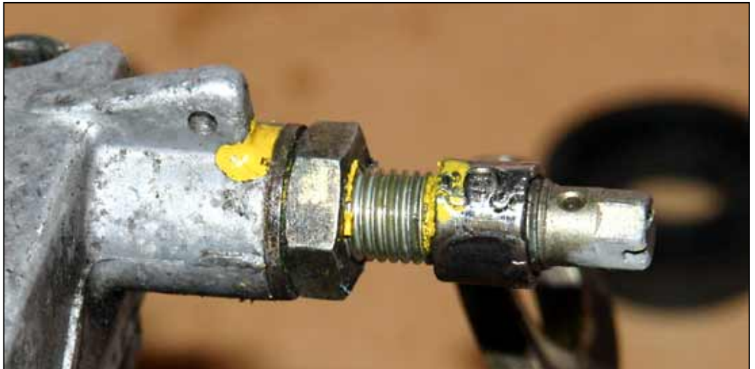
Bild 5: Sieben Umdrehungen herausgedrehte Schraube
