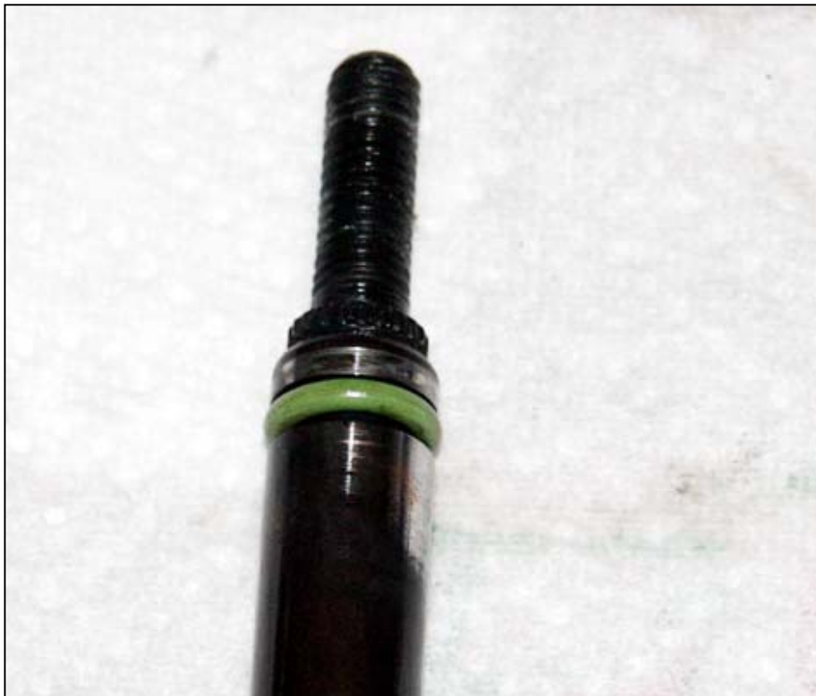
Bild 15: Dieser O-Ring ist der richtige
