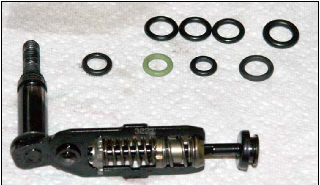
Bild 14: Die ausgebaute Verstellwelle und die möglichen O-Ringe
