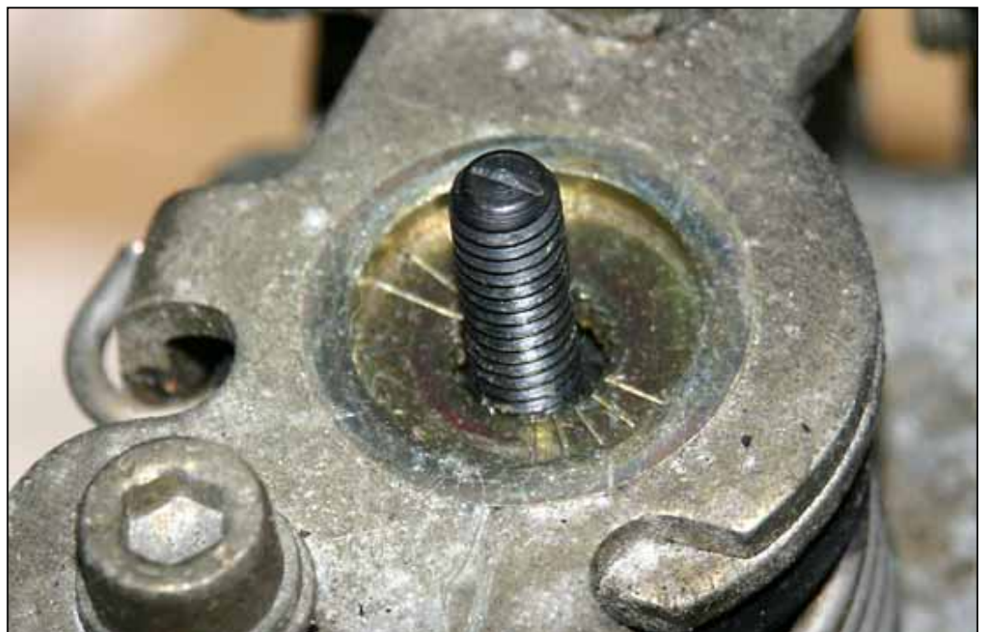
Bild 7: Zu spät! Ich hatte den Gashebel mit der Scheibe von der Welle gezogen und erst dann die Markierungen entdeckt.
