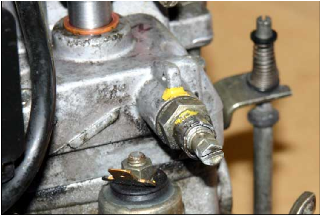
Bild 19: Fördermengenschraube wieder in Ausgangsposition
