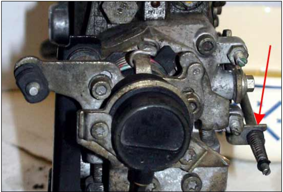
Bild 2: Stange des KSB aushängen
