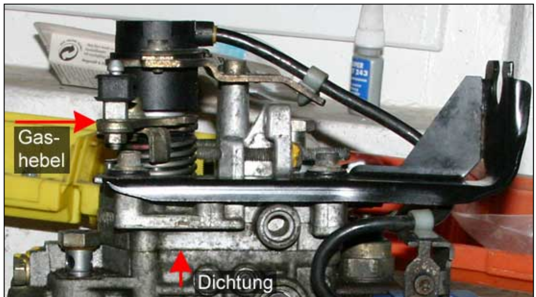
Bild 1: Deckel der ESP VE4...
