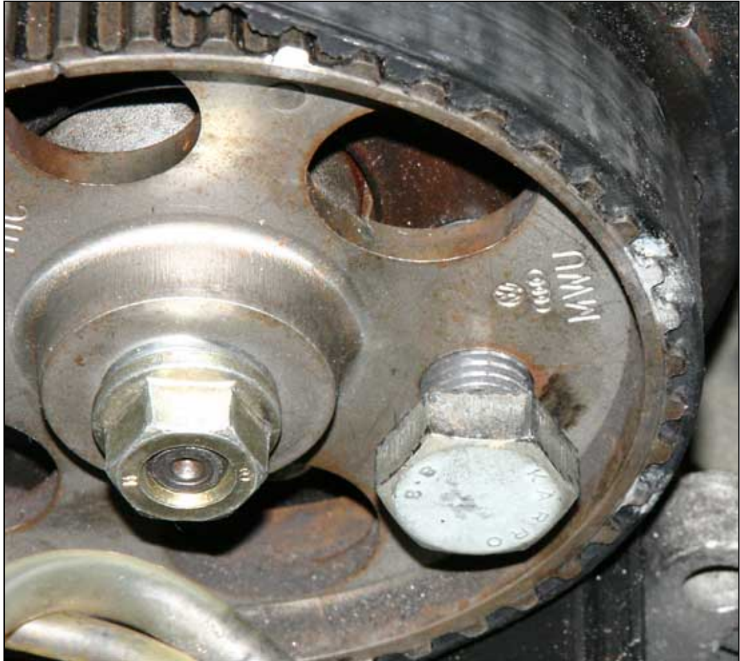
Bild 9: Der Absteckdorn arretiert das ESP-Zahnrad und die Position des Zahnriemens ist markiert
