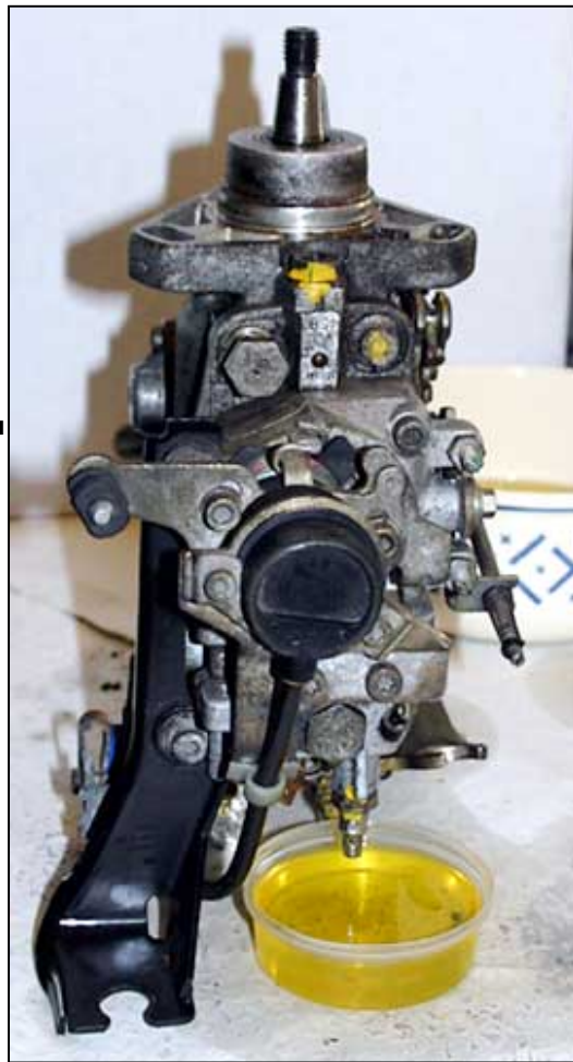
Bild 16: ESP leer laufen lassen - jetzt kann die Dichtaktion beginnen!
