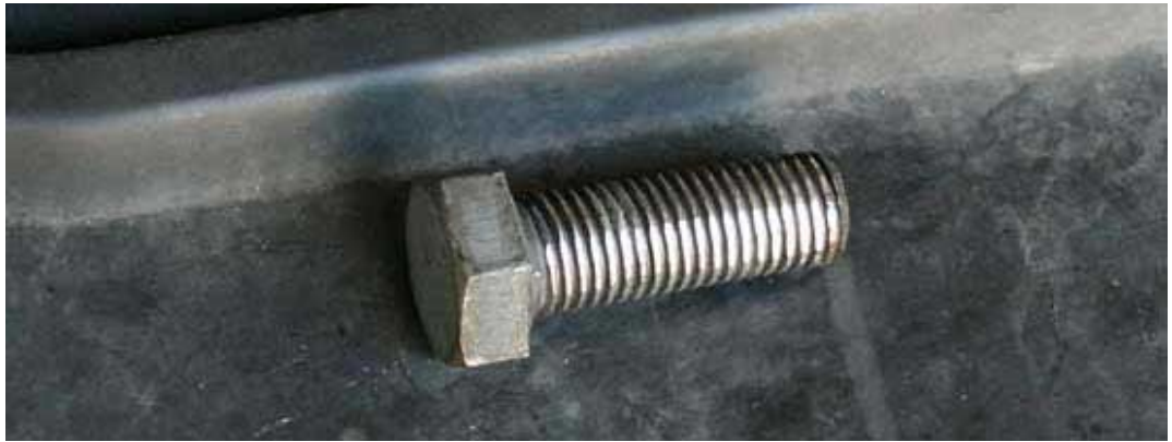
Bild 8: Absteckdorn für die ESP: Eine M16 Schraube zurecht feilen
