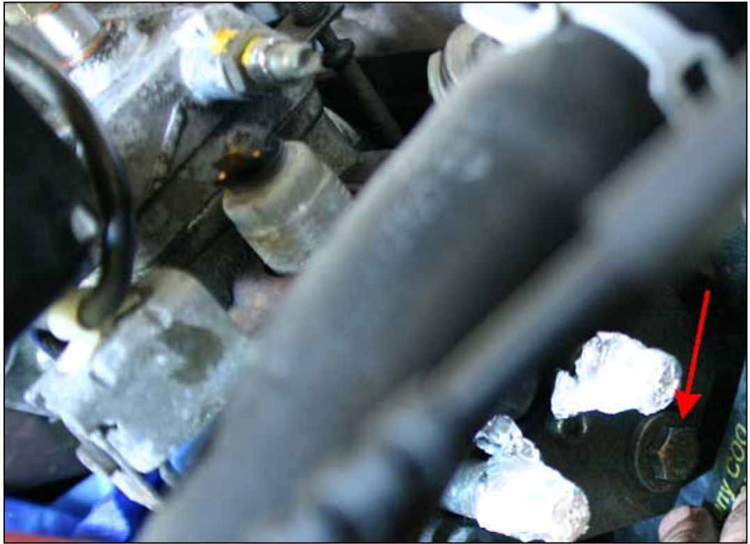
Bild 14: Die 4. Schraube liegt hinter den Anschlüssen für die Einspritzleitungen
